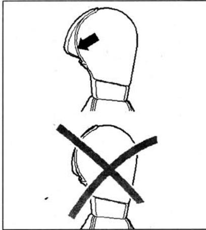
Если это все же произойдет, снять накладку рукоятки (движением вверх). Снова вдавить в паз рычажок тяги -стрелка- и только после этого установить рукоятку. После установки снова заблокировать рукоятку: утопить вниз пластмассовую деталь под рукояткой.
