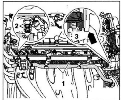
Открутить с двигателя транспортировочную проушину -3--2- и извлечь ее из проушины стрелка-. Установить в эту проушину скобу -10- 222 A /12-.
