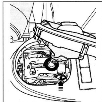
Рукоятку рычага не снимать. Отсоединить фиксаторы чехла рычага селектора и, выворачивая чехол, поднять его рамку к рукоятке. Нажать педаль рабочего тормоза или включить стояночный тормоз. Надавить желтую пластмассовую деталь с правой стороны, чтобы отжать ее влево. Теперь рычаг можно вывести из положения P.
