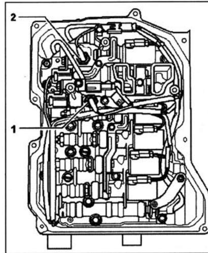
Данные датчики установлены не во всех коробках передач. Место установки: в коробках передач, оснащенных данными датчиками, они находятся в распределительном модуле.
