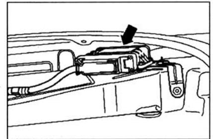
Место расположения: блок управления находится на арке переднего левого колеса. Чтобы демонтировать его или установить, необходимо снять локер переднего крыла.
