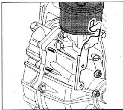
Болтом прикрепить трос к селектору, а новой стопорной шайбой к опоре механизма переключения передач. Установить корпус механизма переключения, теплозащитный экран и систему выпуска ОГ. После установки проверить трос.
