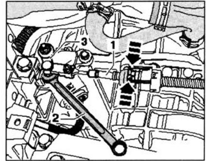
Снять крепление кабеля -1- с болта стартера -стрелка-. Выкрутить верхний болт стартера. Выкрутить верхние болты крепления КП к двигателю.
