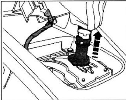
У новых рукояток после разблокировки можно удалить защитную пленку. Извлечь штекер из чехла. Снять рукоятку вверх.
