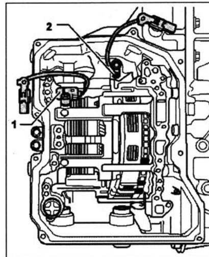
Место расположения: датчики над распределительным модулем в корпусе КП.
