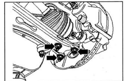
Теперь можно вынуть консоль опоры силового агрегата. Для этого надо немного опустить двигатель вместе с КП с помощью шпиделя траверсы -10 - 222 А-. Достаточно четырех оборотов. Если установлен кронштейн агрегатного узла система выпуска ОГ-КП, снять его. Вывернуть нижние болты крепления КП к двигателю. Для страховки оставить один хорошо доступный болт не вывернутым. Выкручивать следует начинать с двух нижних болтов.
