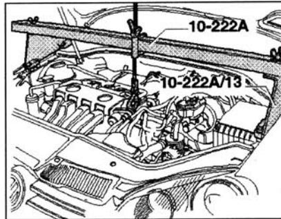
Теперь можно открутить все шесть болтов консоли -А-. При установке прикрутить консоль к коробке передач с моментом затяжки 40 Нм. Для закручивания обоих болтов консоли к автомобилю между обоими болтами с помощью отвертки можно отрегулировать старую посадку болтов. Эти два больших болта затягиваются с моментом затяжки 60 Нм. Консоль вынимается позже!
