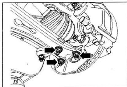
Отжать две полуоси из коробки передач. Снять левый приводной вал. Правую полуось положить как можно выше и закрепить в этом положении. Оберегать валы от повреждения защитного покрытия. Для этой цели использовать пластмассовые кабельные стяжки.
