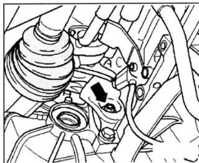
Адаптер -10-222 А 7- повесить на блок двигателя. Снять шланги ОЖ с радиатора ATF. Правый винт затянуть на один оборот (больше не нужно). Подпереть двигатель с КП левым винтом. Не поднимать.
