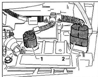
Штекерный разъем под стартером -1- извлечь из крепления и отсоединить. Открутить крепление с нижнего болта стартера. Снять нижний винт стартера и извлечь стартер.
