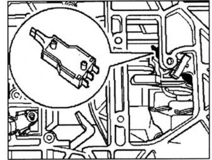
Место расположения: датчик системы Tiptronic встроен в рычаг управления КП. На автомобилях с многофункциональным рулевым колесом проверка подлежат также кнопки на рулевом колесе с их электропроводкой.
