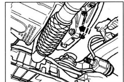
Открутить шесть -гаек гидротрансформатора- с помощью головки ключа -V/175-.
