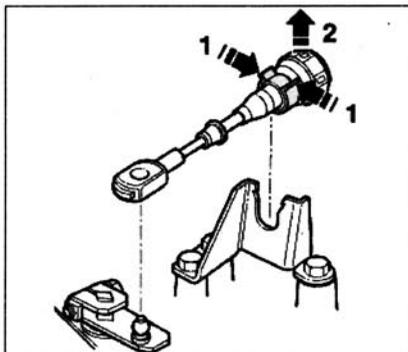
Затем отжать трос с шаровой головки -2-. Отсоединить электрические штекерные разъемы от КП и стартера (многофункциональный переключатель, стартер, провод массы на консоли).
