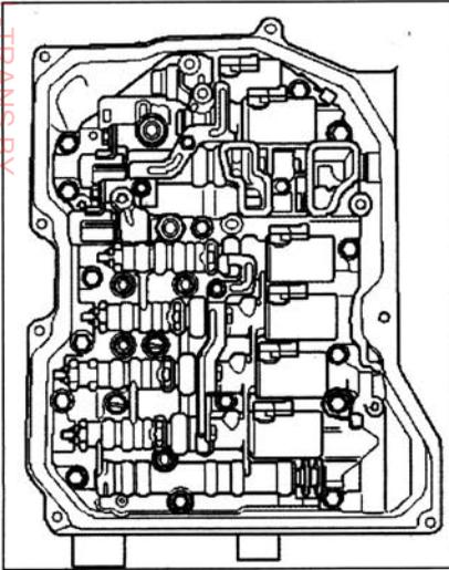
Место расположения: распределительный модуль привинчен снизу к корпусу коробки передач и закрыт масляным поддоном. В распределительном модуле установлены электромагнитные клапаны -N88- и -N89-, а также клапаны регулировки давления -N90-, -N91-, -N92-, -N93-, -N282- и -N283-.
