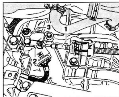
Слегка покачать рукоятку рычага селектора вперед-назад, ни в коем случае не выводя сам рычаг из положения P. При этом, трос принимает оптимальное положение в своей оболочке. Установить рычаг/вал управления переключением передач -3- на коробке передач в положение P (отжать рычаг назад).
