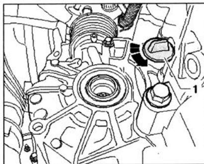
Открутить шесть -гаек гидротрансформатора- с помощью головки ключа -V/175-.
