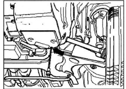
Снять перепускную трубку -1- через контрольное отверстие. Слить ATF. Установить переливную трубку. Плотно закрутить пробку вручную. Залить через заливную трубку 3 литра ATF.
