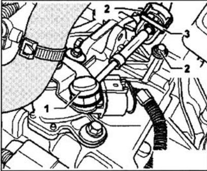
Открутить гайку -1-. Снять с вала переключения передач -4- пружинящую шайбу -2- и рычаг -3-.
