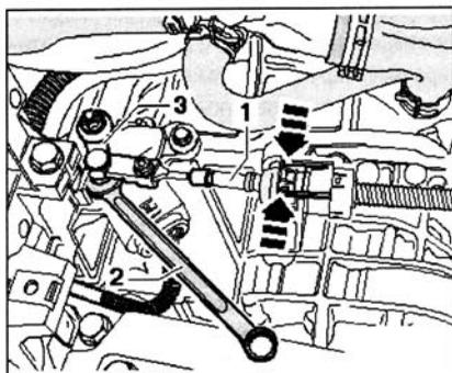
Сжать фиксаторы -стрелки- и вынуть трос из контропоры. Поднять автомобиль. Для дальнейшего снятия тросовой тяги и/или привода переключения КП, необходимо снять теплоизоляционный щиток и в случае необходимости детали выпускной системы. Снять теплозащитный экран. Снять корпус механизма переключения. Чтобы снять тросовую тягу, необходимо отверткой поджать палец-вверх.
