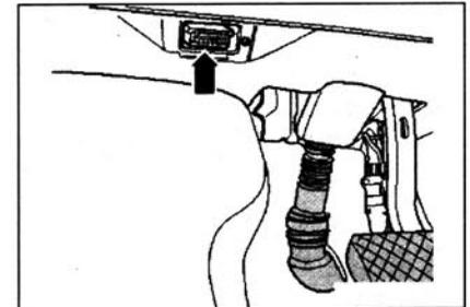
Место расположения: диагностическая колодка -стрелка- установлена слева под накладкой со стороны водителя.
