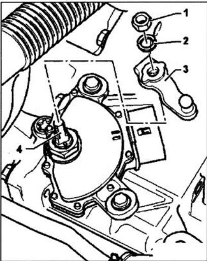
С помощью отвертки разжать язычки стопорной шайбы -2-. Заменить стопорную шайбу, если язычки отломлены. Открутить гайку -1-. Выкрутить болт -5-. Вытащить многофункциональный датчик -4- вместе с шайбами -2- и -3- из вала переключения передач -6-.
