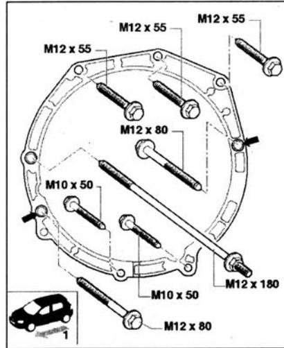
1 - Направление движения. Прокладка поводка на гидротрансформаторе, 60 Нм, 6 штук, снятие и установка с помощью головки ключа -V/175-. M12, 80 Нм, 65 Нм, если использовать накидной ключ -Т10179-. M10, 40 Нм. Эти болты расположены на фланце снизу. Две центровочные втулки на двигателе -стрелки-. Обратить внимание на то, чтобы держатель не касался масляного радиатора. Гайки- 8 Нм
