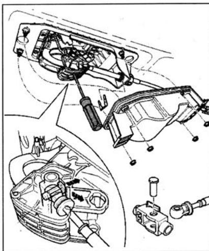
Одновременно отжать вперед -стрелки- фиксирующую -палец- стопорную пластину. Вытащить стопорную пластину. Шайбу можно только заменять. Снять трос рычага.
