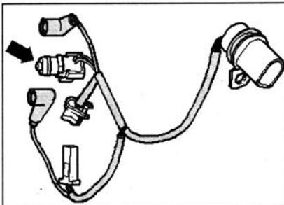
Жгут проводов для датчиков. Со встроенным датчиком температуры рабочей жидкости КП -G93--стрелка-. Место расположения: жгут проводов крепится к распределительному модулю коробки передач.
