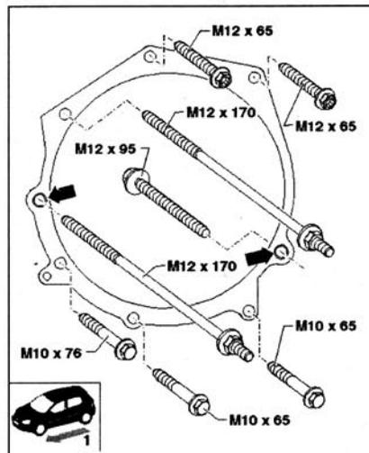
1 - Направление движения. Ведомый диск к гидротрансформатору, 60 Нм, 6 штук, снятие и установка с помощью головки ключа -V/175-. M12, 80 Нм, 65 Нм, если использовать накидной ключ -Т10179-. M10, 40 Нм. Эти болты расположены на фланце снизу. Две центровочные втулки на двигателе -стрелки-. Обратить внимание на то, чтобы держатель не касался масляного радиатора. Гайки- 8 Нм
