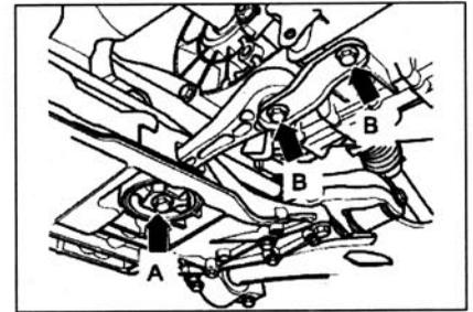
С обеих сторон открутить -гайки- нижнего рычага подвески. Выжать оба приводных вала из КП. Снять левый приводной вал. Правый вал поднять как можно выше и закрепить в этом положении. При этом нельзя повредить защитное покрытие валов, для этого можно использовать пластмассовые кабельные стяжки.
