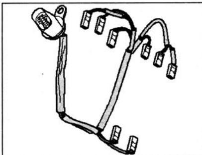
Жгут проводов для электромагнитных клапанов. Место расположения: жгут проводов крепится к распределительному модулю коробки передач.
