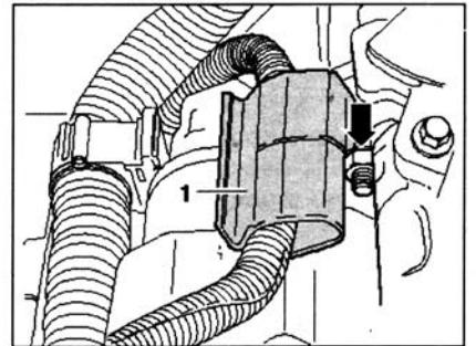
Чтобы можно было подпереть двигатель и КП. Снять кабели -1- с транспортировочной проушины -3-.
