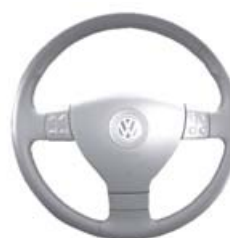
J453 – блок управления приборами на многофункциональном рулевом колесе
